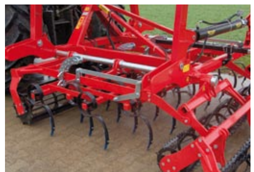
Die Arbeitstiefe wird über das Eggenfeld eingestellt.
